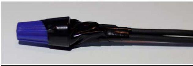
Arrangement recommandé des fils
